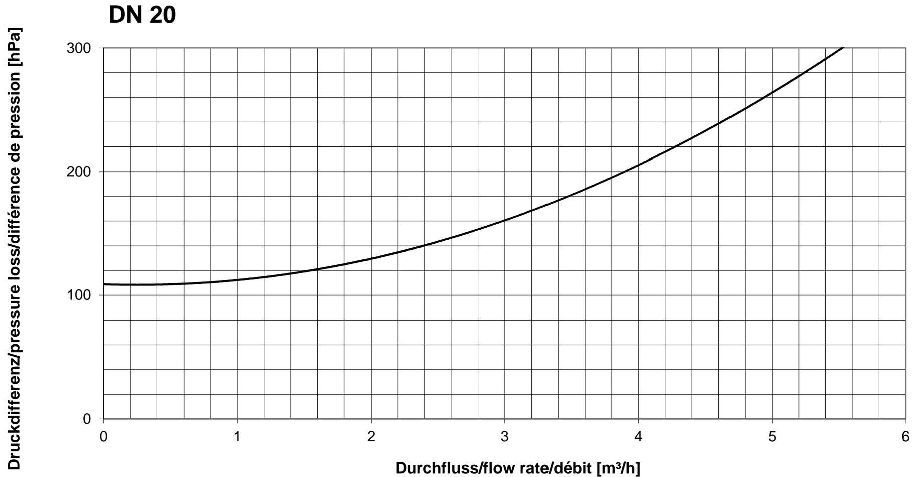
Durchflussdiagramm/Flow Diagram/Diagramme de débit
