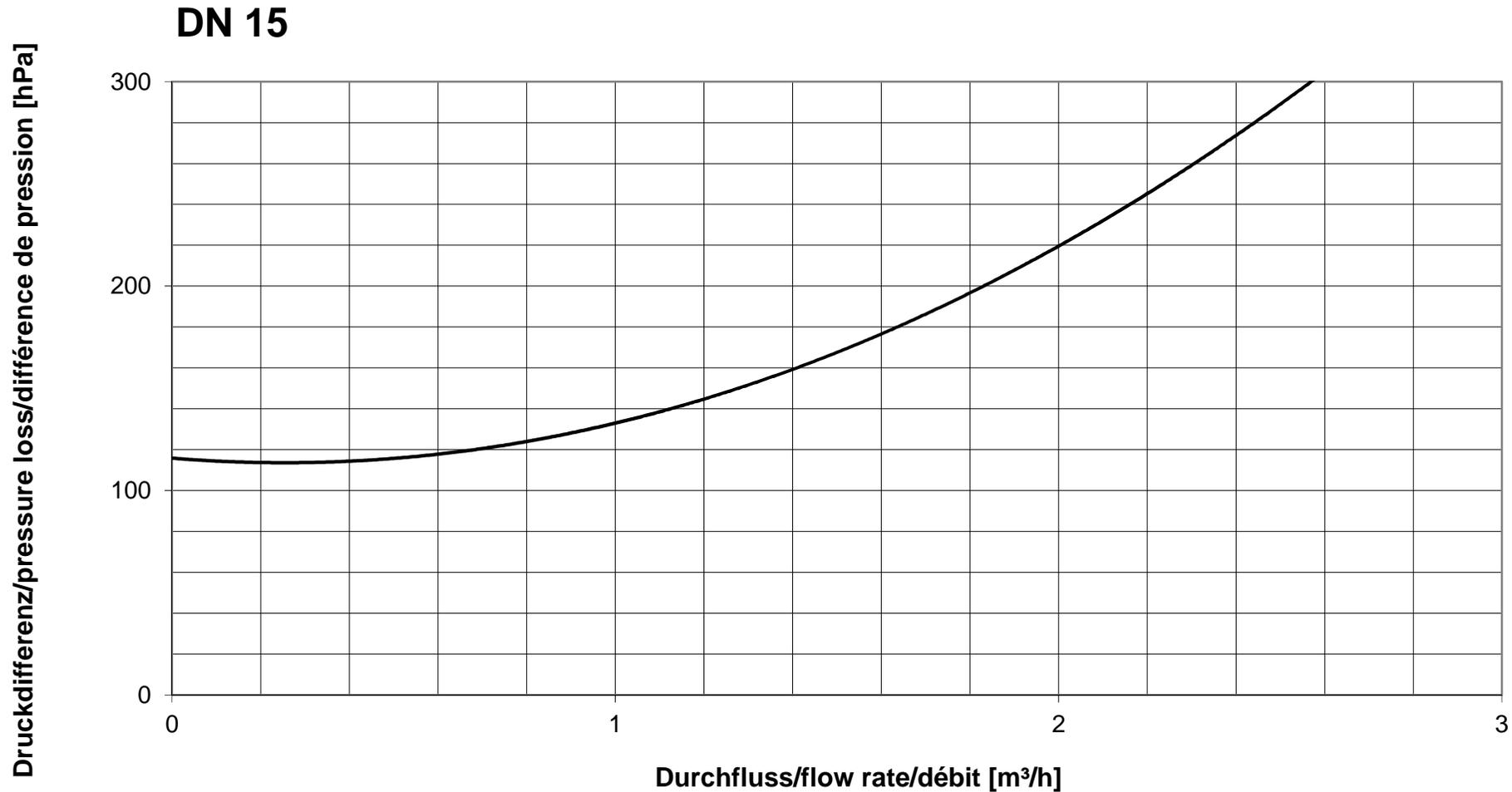
Durchflussdiagramm/Flow Diagram/Diagramme de débit
