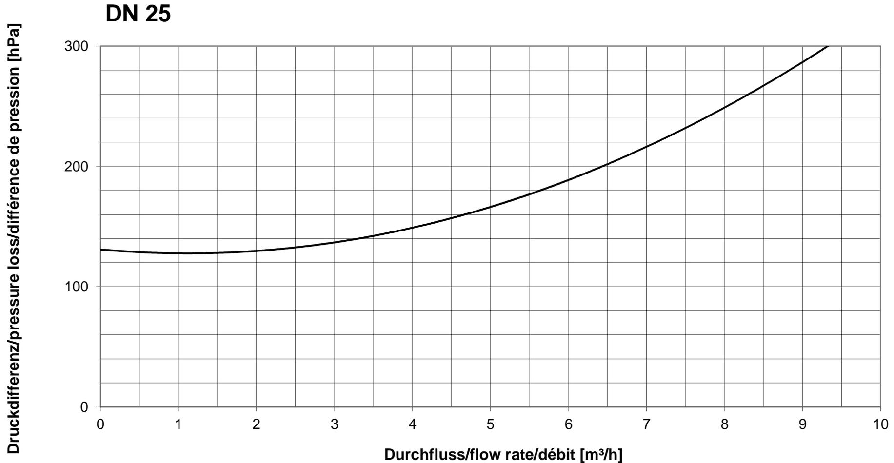
**Durchflussdiagramm/Flow Diagram/Diagramme de débit
