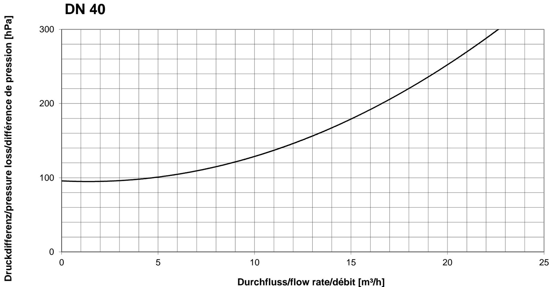
**Durchflussdiagramm/Flow Diagram/Diagramme de débit
