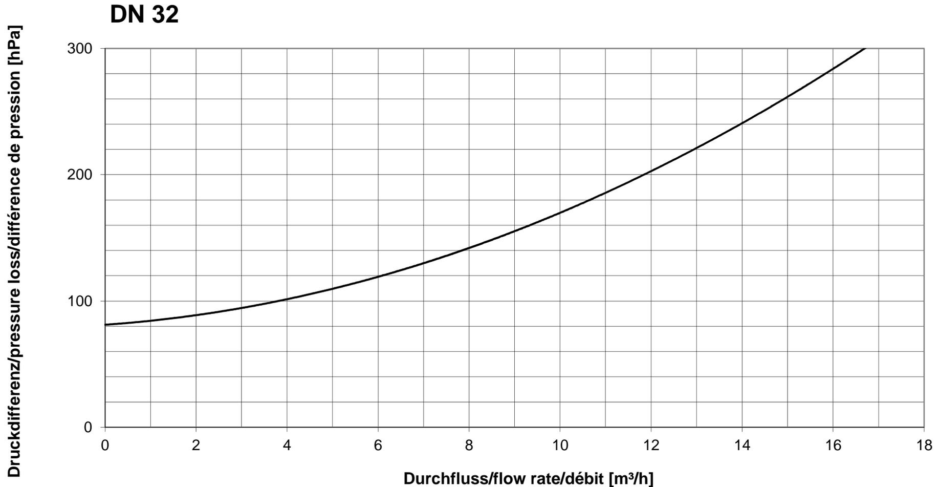
**Durchflussdiagramm/Flow Diagram/Diagramme de débit
